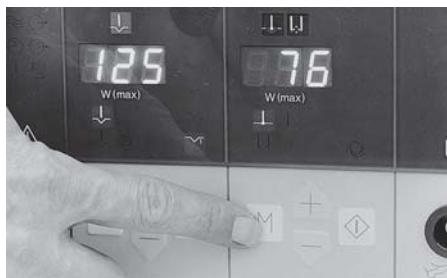
Anschließend die gewünschten Grundeinstellungen für die verschiedenen Koagulationsmodi eingeben. Dazu mit der M-Taste ⑯ die einzelnen Koagulationsmodi anwählen.
