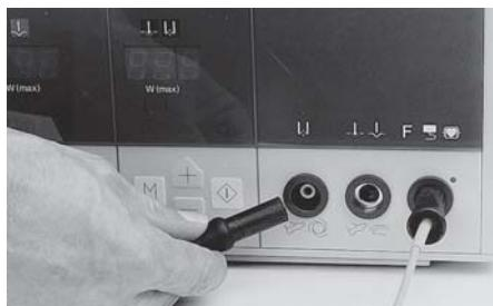
Buchse ⑬ zum Anschluss bipolarer Koagulationselektroden. An diese Buchse angeschlossene Elektroden können nur über den Fußschalter aktiviert werden.
