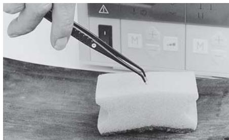
HF-Generator durch Drücken des blauen Fußpedals aktivieren. Gibt der Generator Leistung ab, so muss an der Kontaktstelle Wasser verdampfen. Das entsprechende Aktivierungssymbol „Bipolare Koagulation“ muss aufleuchten und ein akustisches Signal ertönen.
