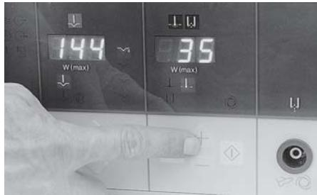
Gegebenenfalls an den  $\pm$  Tasten ⑯ eine von der Grundeinstellung der Frontplatte abweichende Ausgangsleistung einstellen. Die Begrenzung der Ausgangsleistung kann zwischen 1 Watt und 120 Watt eingestellt werden und wird im Display ⑧ angezeigt.
