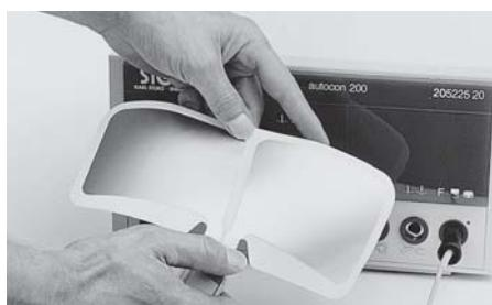
An das AUTOCON® 200 können sowohl einflächige als auch zweiflächige Neutralelektroden angeschlossen werden. Bei korrektem Anschluss leuchtet die Kontroll-Leuchte neben der Anschlussbuchse ⑪ grün; leuchtet die Kontroll-Leuchte nicht, so liegt ein fehlerhafter Anschluss vor.
