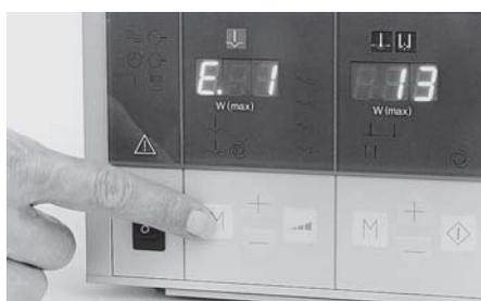
M-Taste ⑯ drücken. Im Display „Schneiden“ erscheint „E“ (Error) und die Nummer des Speicherplatzes. Auf Speicherplatz 1 befindet sich jeweils der zuletzt gespeicherte Fehler.
