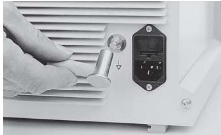
Das Gerät ist mit einer Steckvorrichtung ❸ für den Potentialausgleich ausgerüstet.
