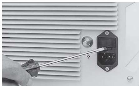
Netzsicherungshalter ⑤ mit einem Werkzeug lösen.
