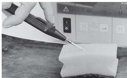
Auf die Neutralelektrode einen nassen Schwamm, Tupfer o. ä. legen und mit der aktiven Elektrode in Kontakt bringen. HF-Generator durch Drücken des gelben Fußpedals bzw. des gelben Schal-ters am Handgriff aktivieren.
