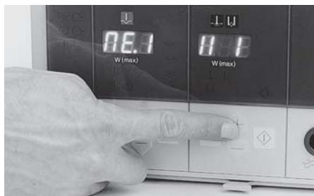
M-Taste ⑯ drücken. Im Display „Schneiden“ erscheint „Ne.“ und die Einstellung 1 (Standard-einstellung), im Display „Koagulation“ erscheint eine entsprechende graphische Darstellung.
