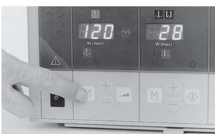
Nach Aufrufen des Programm-Modus mit den  $\pm$  Tasten ⑯ im Koagulationsfeld die Programm-Nummer 1 anwählen. Anschließend M-Taste ⑯ drücken. Im Anzeigenfeld „Schneidemodus“ ③ leuchtet der voreingestellte Wert für die Betriebsart „Unipolarer Schnitt“ auf.
