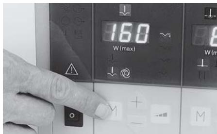
Erneut die M-Taste ⑯ drücken. Das Symbol für die Betriebsart „ENDOCUT“ leuchtet auf (nur wenn das Gerät mit dieser Zusatzfunktion ausgestattet ist).
