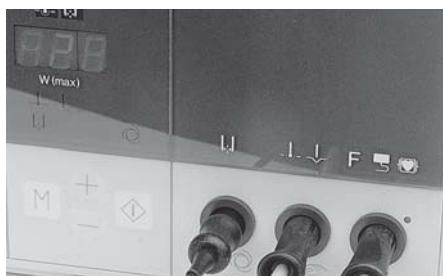
**Warnung:** An die Buchsen ⑫ und ⑬ können 2 Elektroden gleichzeitig angeschlossen und aktiviert werden. In diesem Fall darauf achten, dass die Elektroden so abgelegt werden, dass eine Verwechslung ausgeschlossen ist. In Zweifelsfällen muss eine Probeaktivierung der Elektroden vor Einführung in den Patienten vorausgehen.
