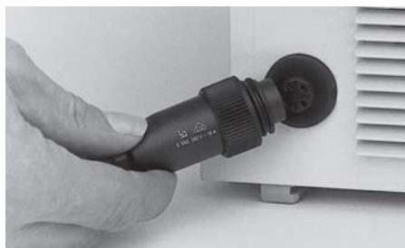
Verbindungskabel des Fußschalters in Buchse ② einstecken und Überwurfmutter festschrauben.
