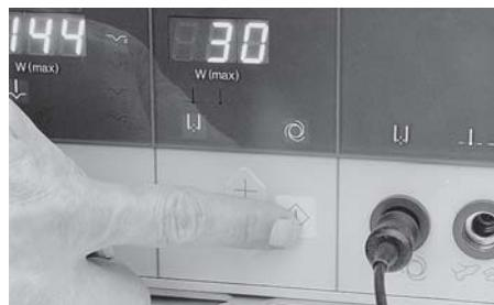
Um die Autostart-Funktion zu aktivieren, wird die Taste ⑯ solange gedrückt, bis das Autostart-Symbol hinterleuchtet ist.
