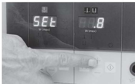
Nun mit den  $\pm$  Tasten ⑯ die gewünschte Einschaltverzögerung im Bereich zwischen 0 und 10 Sekunden eingeben.
