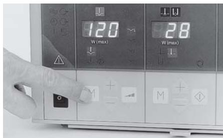
Gegebenenfalls an den ± Tasten ⑩ eine von der Grundeinstellung der Frontplatte abweichende HF-Ausgangsleistung einstellen. Die Begrenzung der Ausgangsleistung kann zwischen 1 Watt und 200 Watt festgelegt werden und wird im Display ④ angezeigt.
