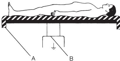
Da bei einer derartigen Berührung die Kontaktflächen in der Regel relativ klein sind, könnten hochfrequente Leckströme durch lokal hohe Stromdichten Verbrennungsnekrosen verursachen. Eine schlecht angelegte Neutralelektrode verstärkt diesen Effekt.
