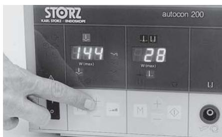
An der M-Taste ⑯ einen unipolaren Schneide-modus oder an der M-Taste ⑯ einen unipolaren Koagulationsmodus wählen und die Leistungs-begrenzung mit den ± Tasten ⑯ bzw. ⑮ auf Maximum stellen.
