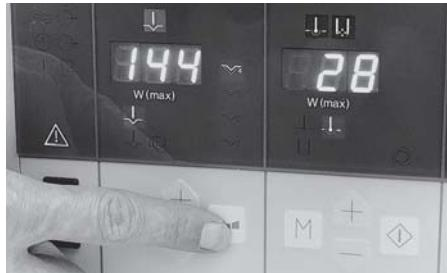
Gegebenenfalls einen von der Grundeinstellung abweichenden Koagulationseffekt beim Schnitt festlegen. Dazu durch Drücken der Taste ⑦ eine der Stufen 1 (minimaler Koagulationseffekt) bis 4 (maximaler Koagulationseffekt) vorwählen. Die gewählte Stufe wird im Anzeigenfeld ⑥ hinterleuchtet.
