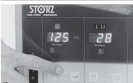
Mit den  $\pm$  Tasten ⑯ die gewünschte Leistungsbegrenzung eingeben. Der eingegebene Wert wird im Display ④ angezeigt. Mit Taste ⑰ den gewünschten Koagulationseffekt der Schnittränder eingeben.
