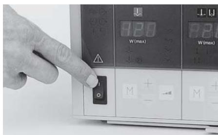
Nachdem für jeden Koagulationsmodus die gewünschten Parameter eingegeben worden sind, wird das Gerät am Netzschalter ① ausgeschaltet. Damit ist die Grundeinstellung gespeichert und wird bei jedem Einschalten des Netzschalters automatisch eingestellt.
